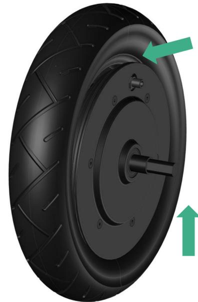
1. Sobald die Luft komplett aus dem Reifen abgelassen ist, kannst du den Reifen von der Felge lösen.
