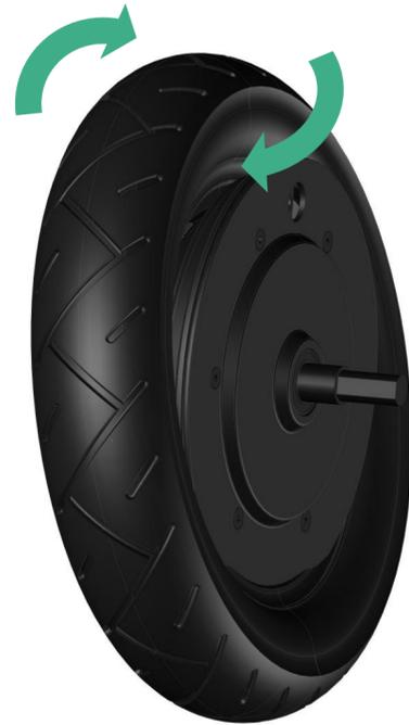
1. Setze den **Montierhebel** auf der Seite an, genau dort, wo die Reifenflanke am meisten über den Felgenrand schaut. Der grüne Pfeil zeigt, wo der Hebel zwischen Reifenflanke und Felgenhorn angesetzt wird (siehe Bild 1).
